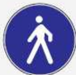
Figura II 88 art. 122 Percorso pedonale
